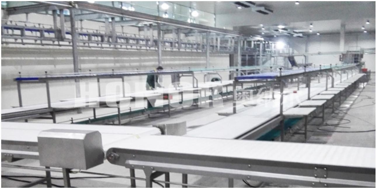
屠宰生产线的屠宰工艺流程布置做到清洁区与非清洁区严格分开，防止产品受到交叉污染，所有加工车间均采用单层水平布置，局部设二层，用作生活用房及参观走廊。采用流水线生产，从非清洁区开始随工艺流程逐渐进入清洁区。非清洁区设有待宰、淋浴、放血、烫毛等工序，半清洁区设有胴体加工、同步检验、副产品加工等工序；清洁区设有两段冷却、剔骨分割、包装、鲜销、入库等工序。生产区与生活区进行合理分区，屠宰生产线车间内部设有卫检、消毒设施和高压清洗设备，并设有男女\*\*\*室、淋浴室和厕所，入口处均设有洗手盆及消毒池。在工艺设计中，采用宰前检疫，多点监控，按工序设检验岗位。分设头检、旋检、肠检、胴体及内脏同步检验等工序。对毛皮、内容物、废弃物采用压缩空气管道吹送的方法，送至暂存区，减少屠宰设备的交叉污染及平面运输。车间的交叉污染及平面运输。奥纳尔制冷科技已实现生产规模化、管理现代化、服务配套化。淄博生猪屠宰分割输送线安装
