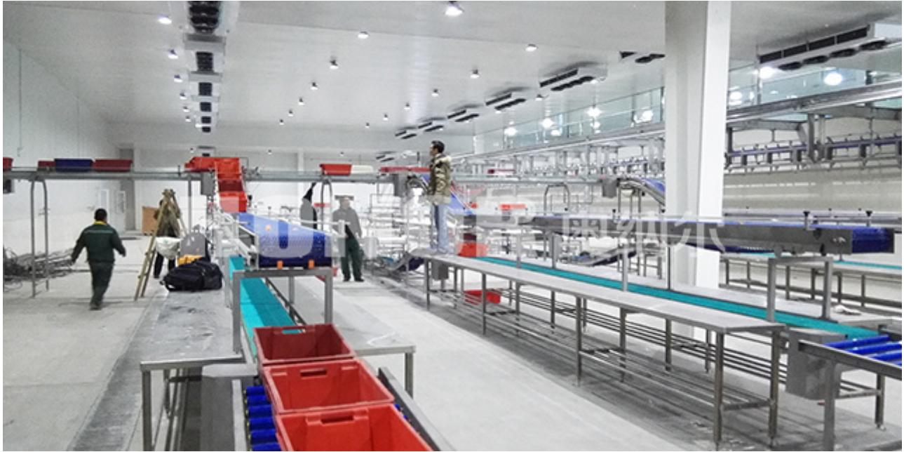
屠宰分割输送线是指用于畜类及家禽等肉制品在宰杀后根据食用、烹煮方式对其进行分割时输送的一款输送设备。该设备用于输送被分割成段的猪(羊)肉，以便于输送线两侧的工人在线完成对分割肉的剔骨及细分割。在肉类分割过程中，实现了全程输运、分割等物流的自动化分割后产品输送带采用立体化的三层结构，有效节省了空间，减少了工人的活动范围，在工位上就可以完成任务，有效提高了生产效率。该机两侧带工作台式。常与分段输送机配合使用。适用于屠宰加工厂和分割车间使用。屠宰分割输送线主要由机架、输送带、托辊、从动滚筒、工作台和减速机组成。工作台分单体式和连体式两种。
